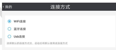
选择 **WIFI** 通讯方式时，则平板显示器需打开 **WiFi** 开关，并在平板系统中连接到名称为“**QY-ET\*\*\*\***”的 **WIFI** 网络。**请注意**，由于安卓系统的设定需同时打开平板“**位置信息**”。
